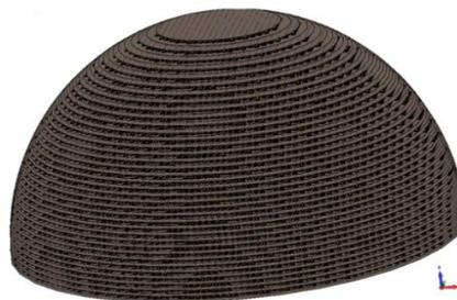
Рис. 2.37. Полусферическая метаматериальная линза
