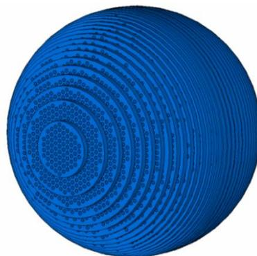
Рис. 3.12. Сферическая линза Люнеберга из диэлектрических перфорированных дисков
