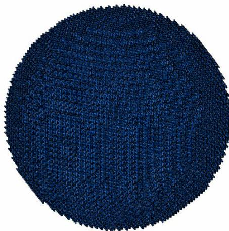
Рис. 3.20. Сферическая линза Люнеберга, состоящая из диэлектрических кубиков
