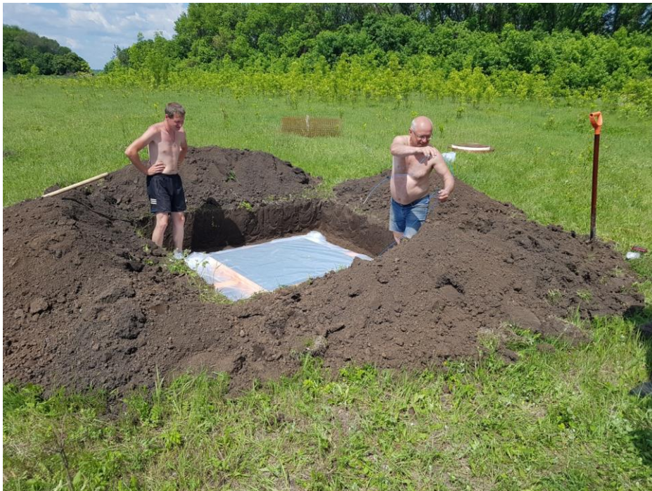
Рис. 3.20. При размещении антенны в полости расстояние от верха антенны до уровня земной поверхности составляло около 0.3 м
