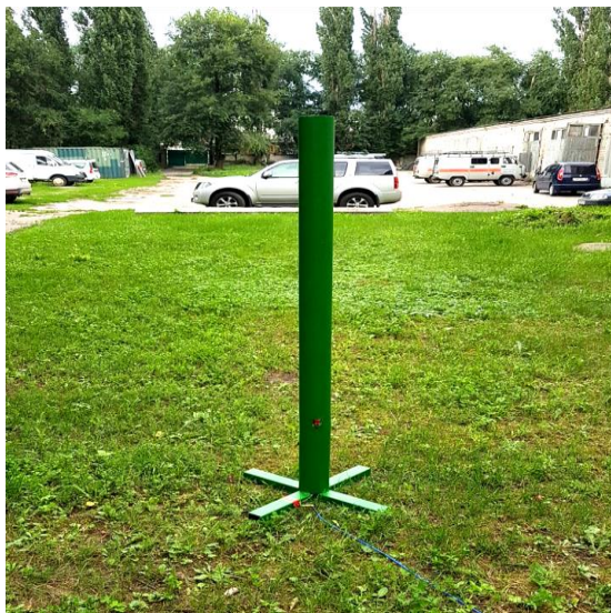
Рис. 2.22. Фото макета тонкого монополя с шунтовым способом питания
