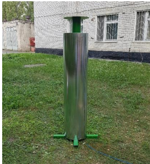
Рис. 2.27. Макет монополя с верхней запиткой и внешней заземленной опорой
