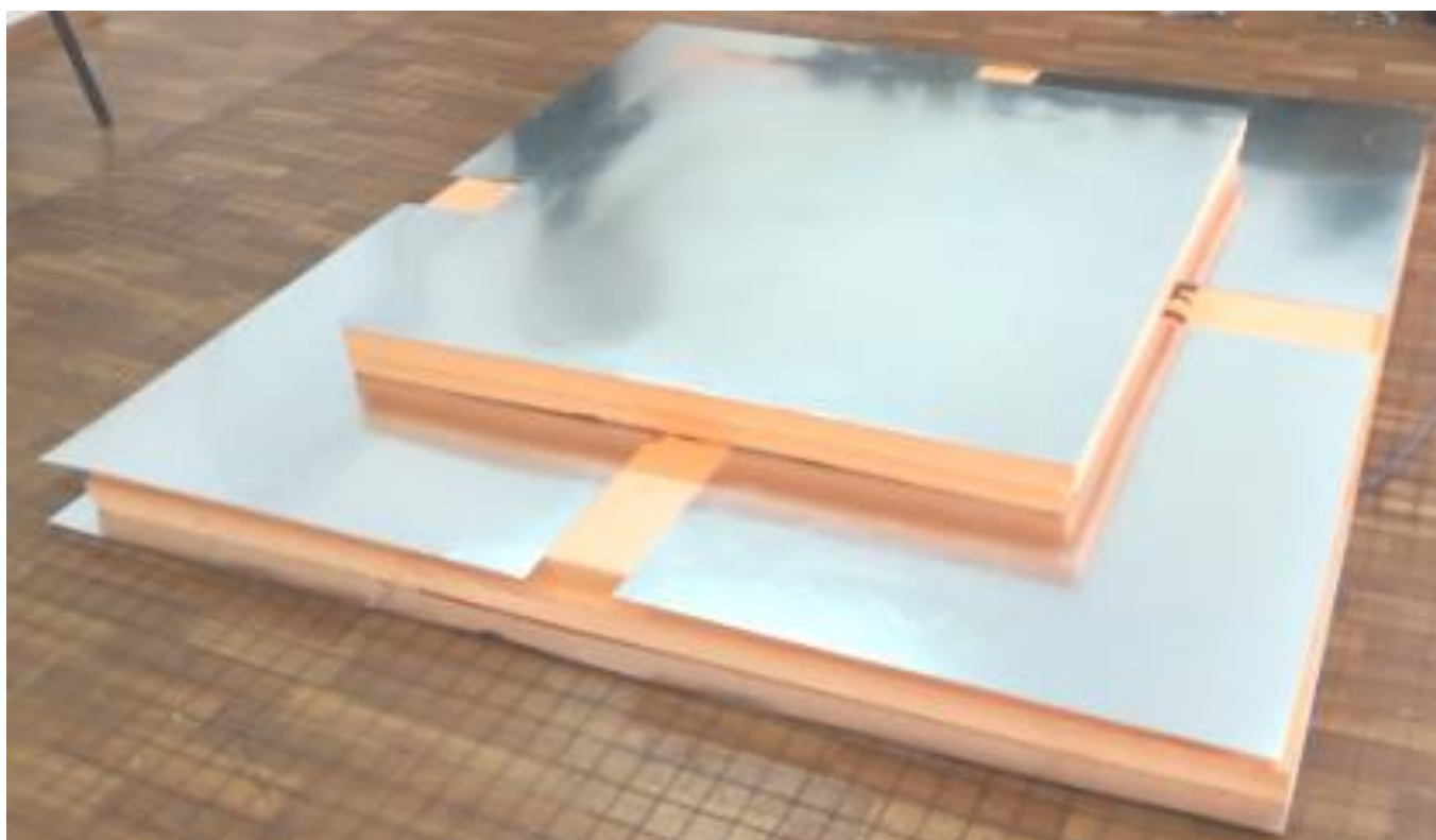
Рис. 3.14. Макет патч- антенны с метаматериальной подложкой и основанием из пеноплэкса
