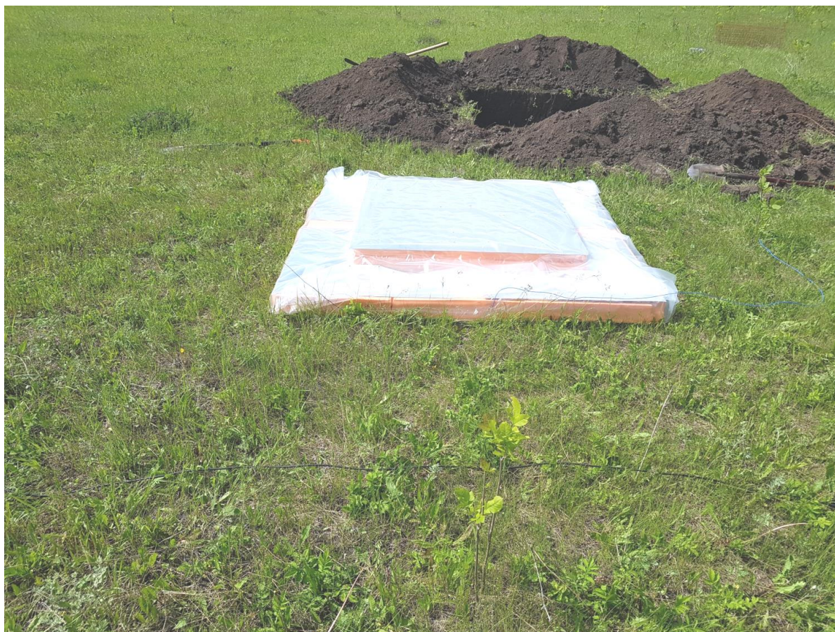
Рис. 3.18. Макет антенны патч- типа с метаматериальной подложкой в полиэтиленовой пленке перед проведением испытаний
