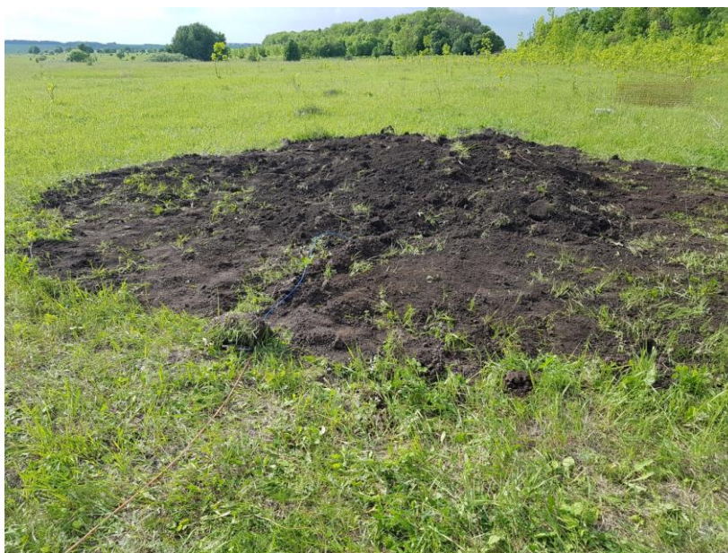
Рис. 3.21. Полость с патч- антенной засыпана слоем грунта, возвышение слоя грунта относительно уровня земли составляет 0.2 м, а общая толщина слоя грунта над антенной – 0.5 м
