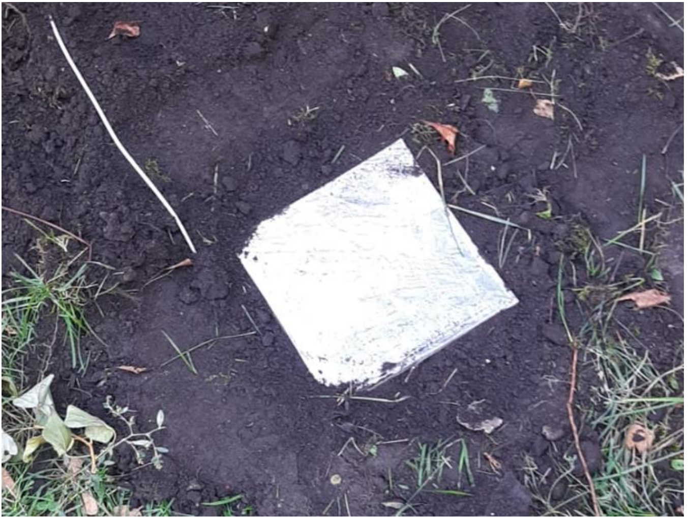
Рис. 4.22. Антенна расположена в грунте, верхняя грань слоя изоляционного материала находится на одном уровне с поверхностью грунта
