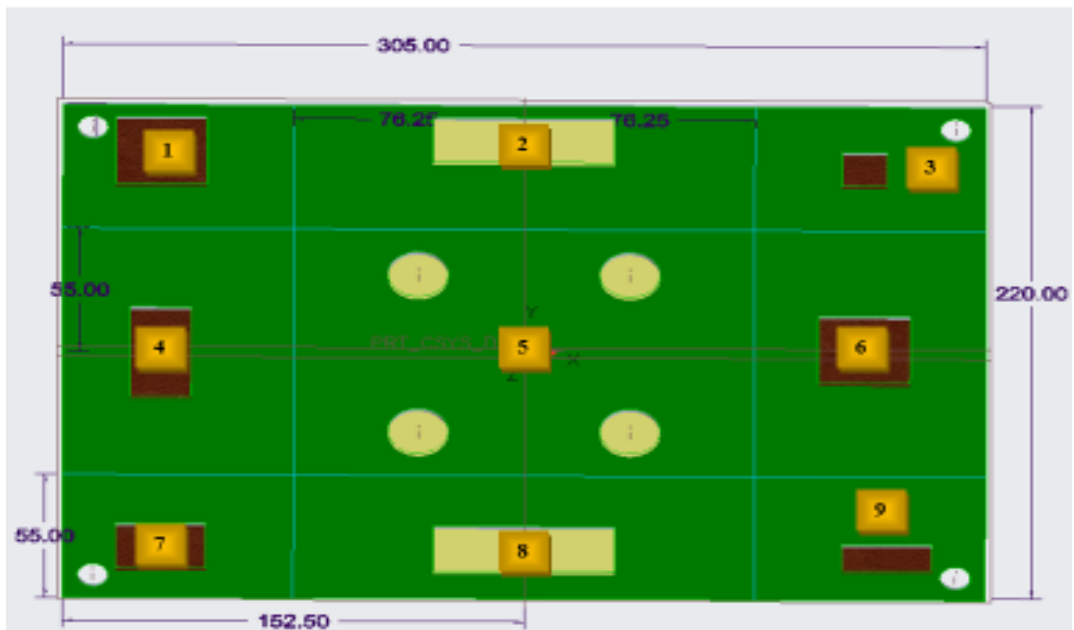
Рисунок 4.4 – Модель печатной платы, которая разделена на девять областей
