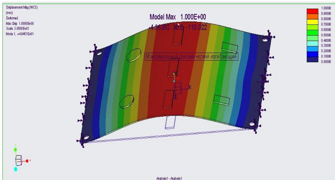
Рисунок 2.12 – Максимальное динамическое изгибающее перемещение в случае резонанса (первая собственная частота)
