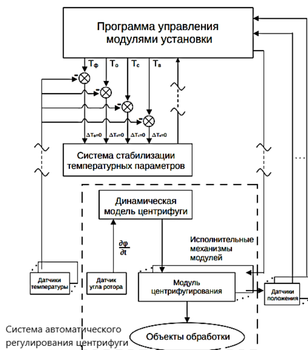
Рисунок 1 – Структурная схема АСУ технологического процесса нанесения фоторезиста
