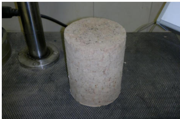
Рисунок 3.1 – Образцы из суглинка тяжелого с примесью мела, обработанного цементом и полимерной добавкой
