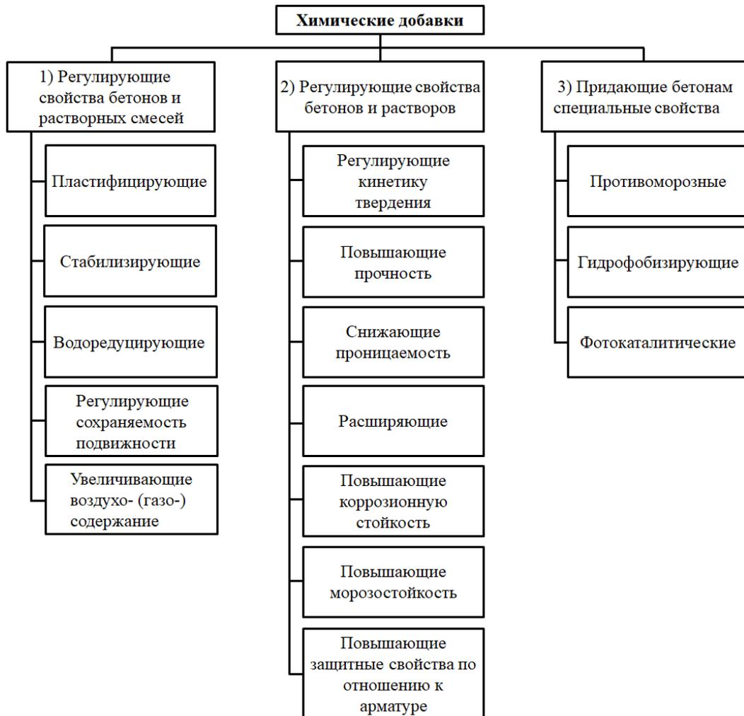
Рисунок 1.1 – Классификация химических добавок для цементных композиций по основному эффекту от их действия [75]
