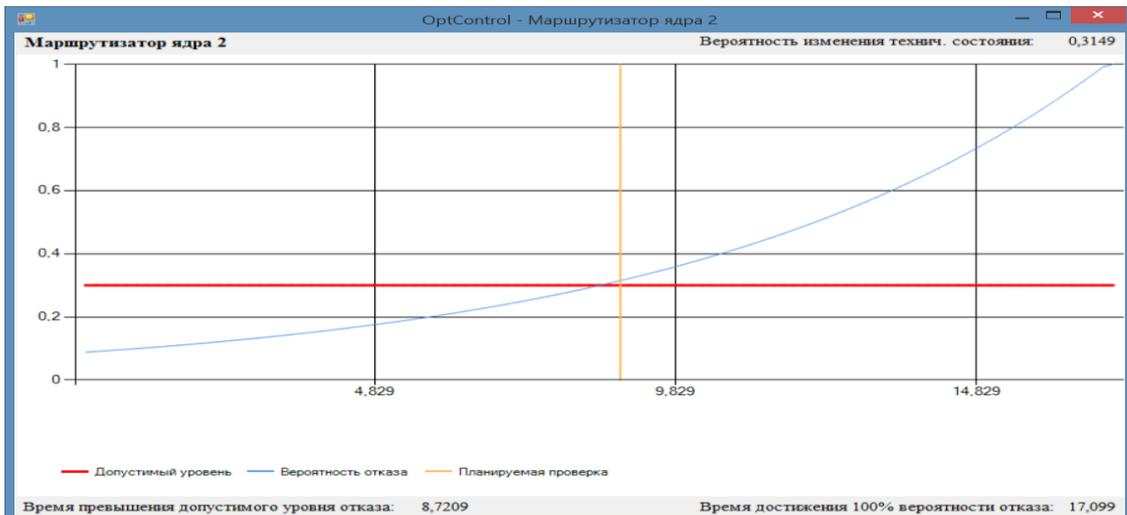
Рисунок 3.7 – Временная зависимость изменения состояния РСЦ с допустимой границей его нахождения в работоспособном состоянии
