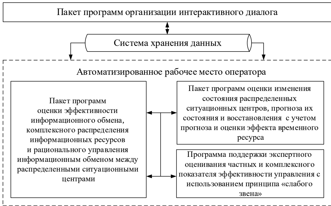
Рисунок 8 – Структурная схема программного комплекса поддержки принятия решений при управлении в организационных системах, реализующих структуру РСЦ
