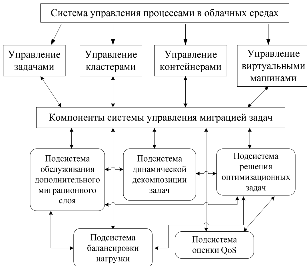
Рис. 4.8. Архитектура системы управления распределением заданий в облачных средах
