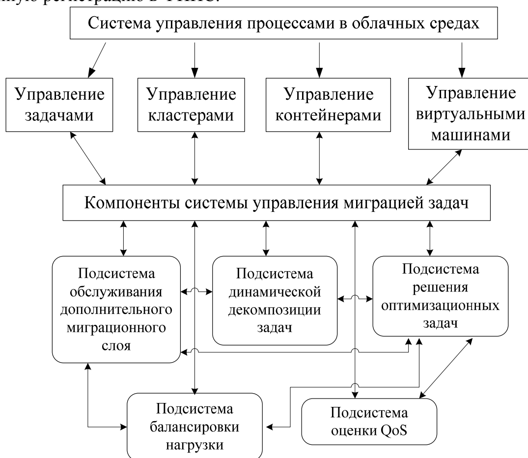
Рис. 4.3. Структура программного прототипа системы управления распределением заданий в облачных средах
