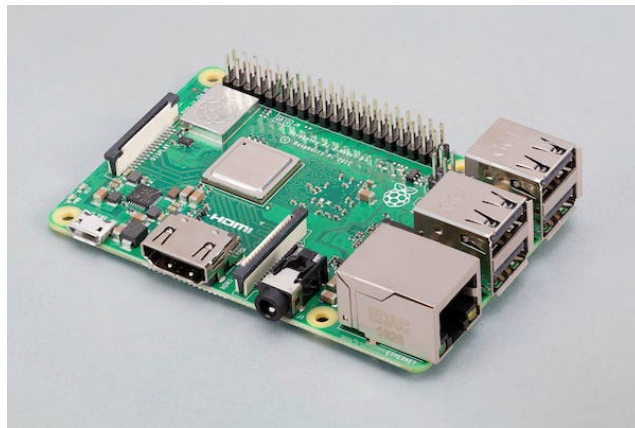
Рисунок 4.4 – Одноплатная вычислительная платформа «Raspberry Pi 3 Model B+»
