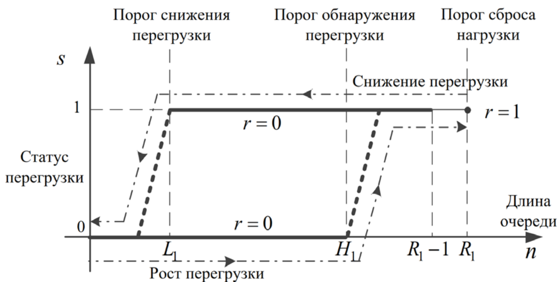
Рисунок 1.25 – Представление статуса моментов нестационарности (перегрузка) в гистерезисном алгоритме управления
