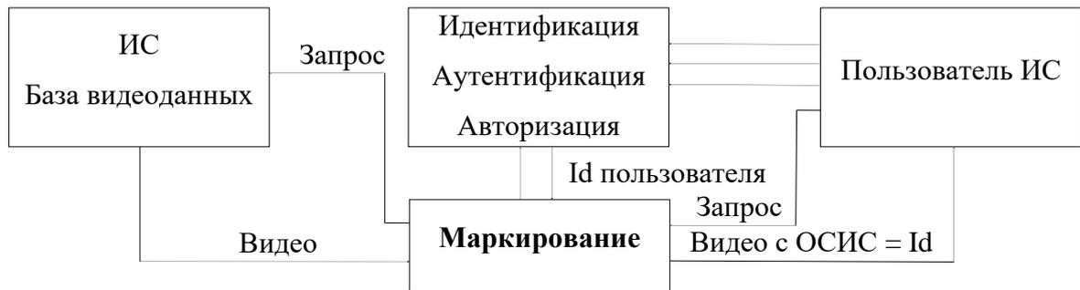
Рисунок 2.1 – Схема информационной системы с маркированием видео
