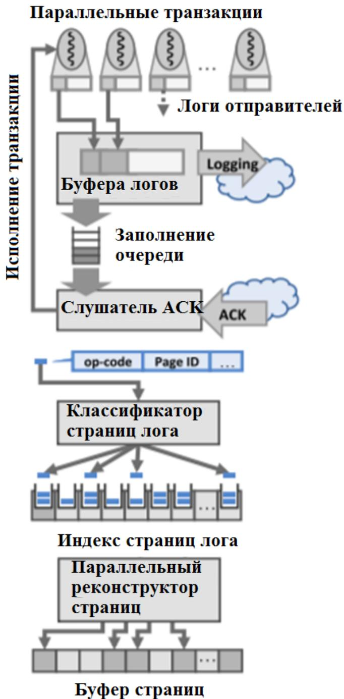
Рис. 4.2. SO-DBMS компоненты
