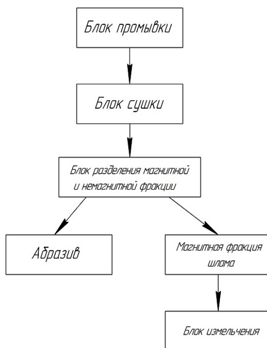
Рисунок 1.1. Общая технологическая схема переработки шламовых отходов
