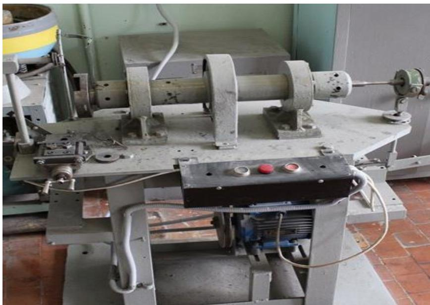
Рис. 4.1. Установка для усталостных испытаний У-20
