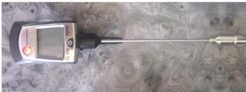
Рис. 2.10. Термометр TESTO 905-T2
