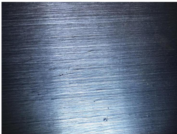
Рис. 2.23. Микротрещина на поверхности образца
