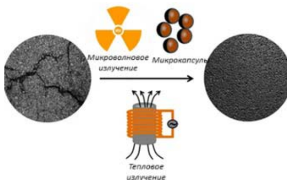
Рис. 2. Принцип действия индукционного нагрева покрытия
