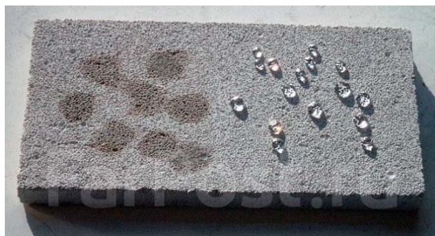
Рис. 3. Пример работы пропиточного состава на поверхности каменного материала, слева поверхность впитала воду, справа после пропитки вода в виде капель на поверхности
