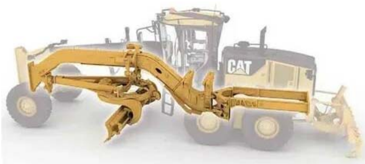
Рис. 2. Конструкция основной рамы и навески отвала автогрейдера
