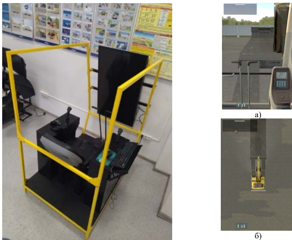
Рис. 1. Тренажер одноковшового гусеничного экскаватора: а – снимок экрана с видом из кабины; б – с видом сверху
