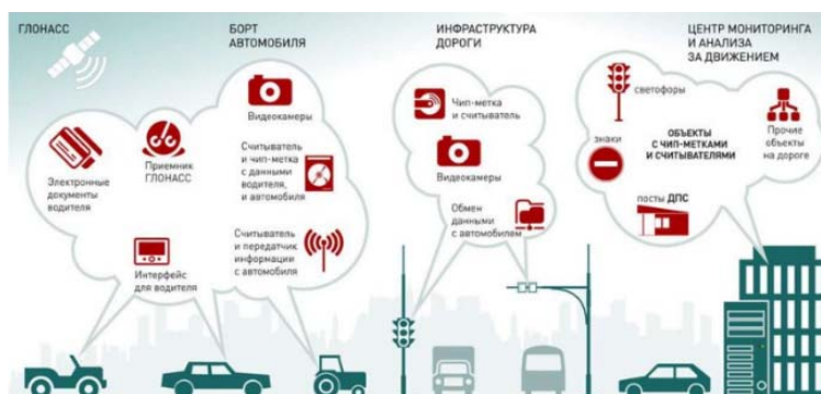
Рис. 2. Схема устройства ИТС в России
