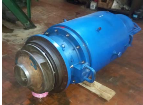
Рис. 3. Рабочее колесо центробежного насоса после обрезки лопатки
