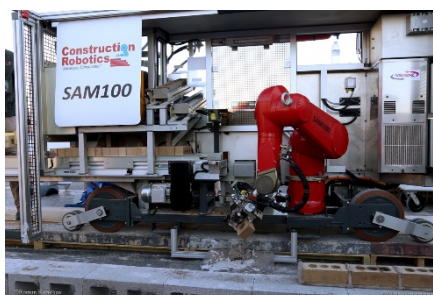
Рис. 2. Полуавтоматический робот-каменщик SAM 100
