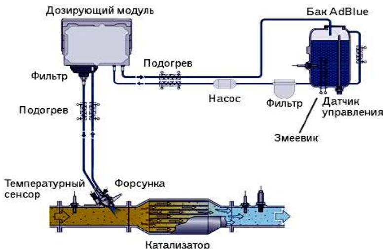
Рис. 6. Схема селективной каталитической нейтрализации
