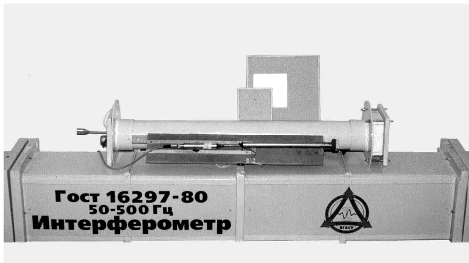
Рис.1. Акустические интерферометры для измерения нормального коэффициента звукопоглощения
