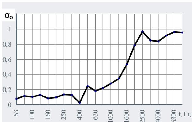
На рис. 3 представлена зависимость нормального коэффициента звукопоглощения  $\alpha_0$  от частоты звука  $f$ , Гц в 1/3-октавных полосах частот при различной толщине звукопоглощающей конструкции.
