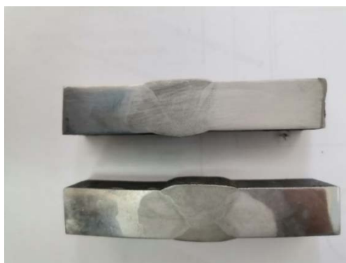
Рис. 5 - Макрошлифы контрольных сварных соединений
