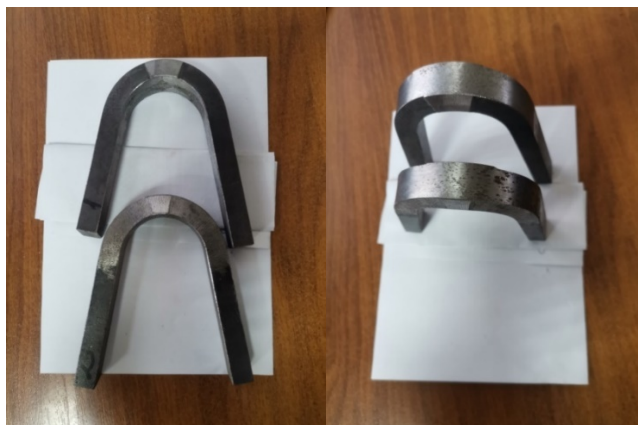
Рис. 4 - Внешний вид испытанных на статический изгиб образцов сварных соединений
