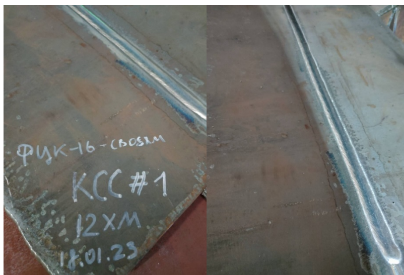
Рис. 2 - Внешний вид контрольного сварного соединения стали марки 12ХМ, выполненного проволокой Св-08ХМ в сочетании с керамическим флюсом ФЦК-16
