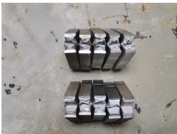
Рис. 3 - Внешний вид образцов металла сварных швов после проведения испытаний по определению ударной вязкости
