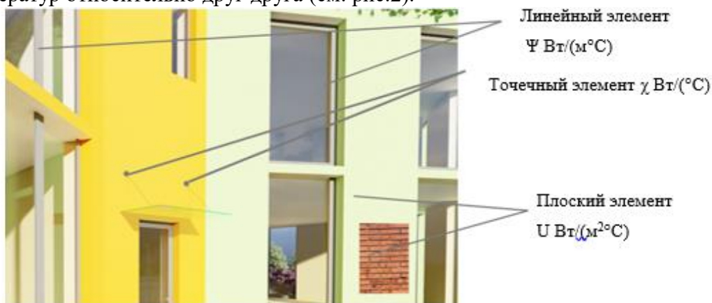
Рис. 2 – Классификация теплотехнических неоднородностей на примере фрагмента фасада многопрофильного досугового центра
