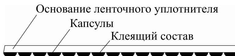
Рис. 2 – Модель ленточного уплотнителя швов аэродромных покрытий
