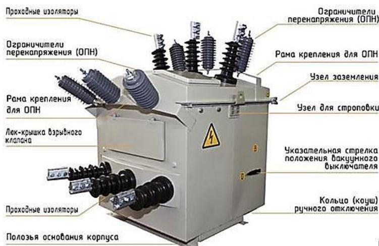
Рис. 1. Пункт секционирования
