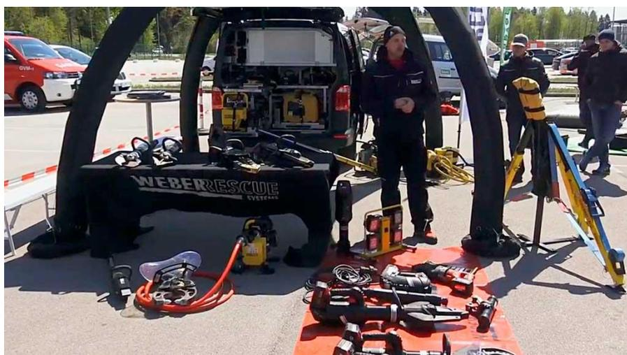
Рис. 1. Комплект гидравлического аварийно - спасательного инструмента (ГАСИ)
