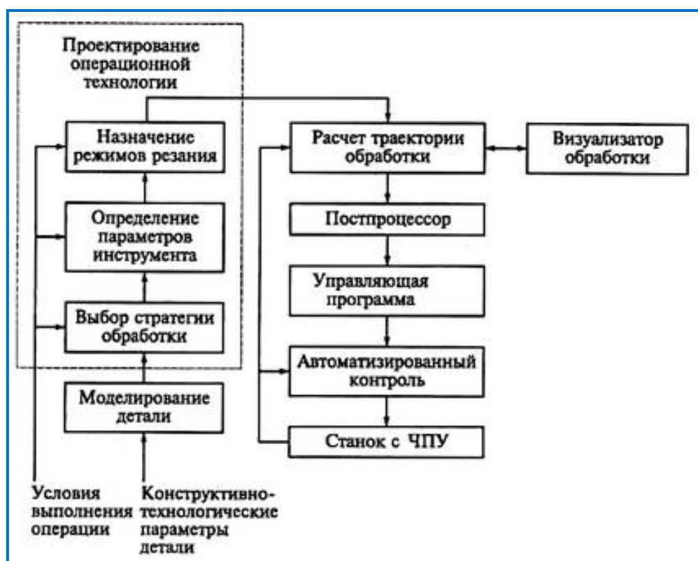
Рис. 2. Схема разработки управляющих программ для станков с ЧПУ
