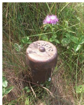
Рис. 2. Внешний вид и схема конструкции грунтового опорного репера
