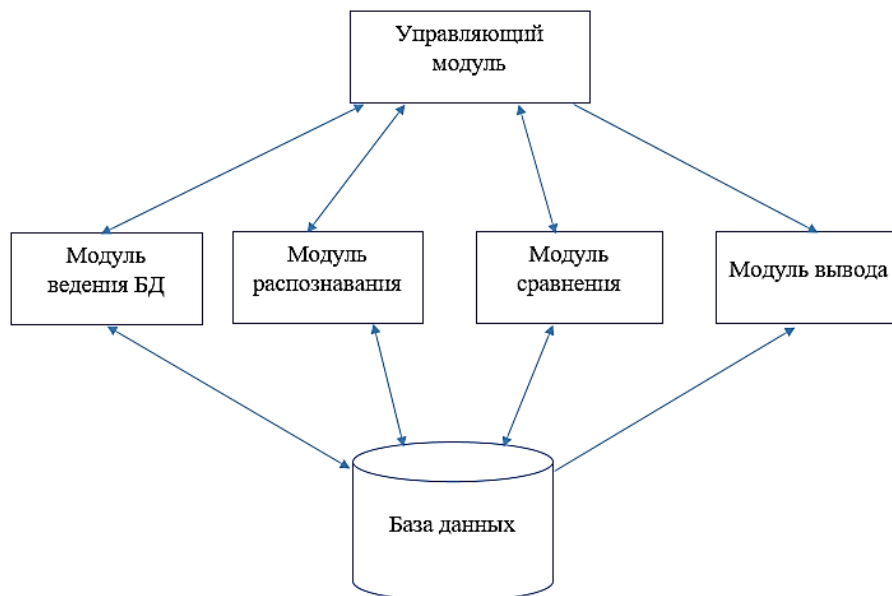
Рис. 1. Функциональная структура информационной системы
