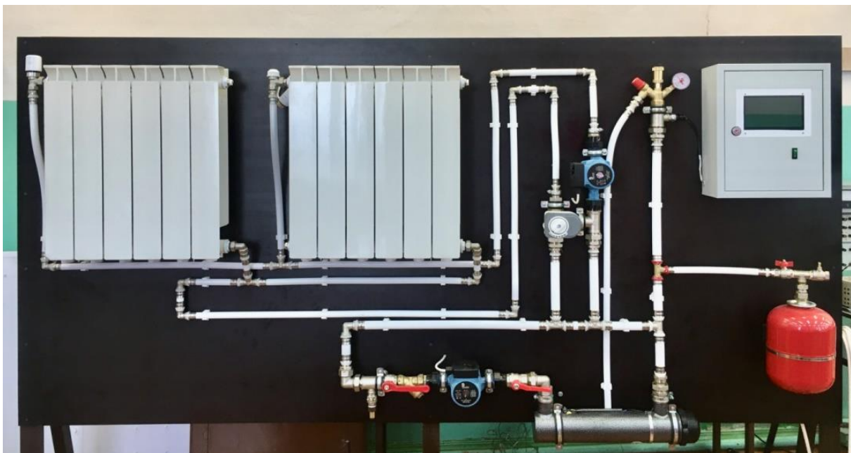
Рис. 6. Лабораторный стенд системы отопления
