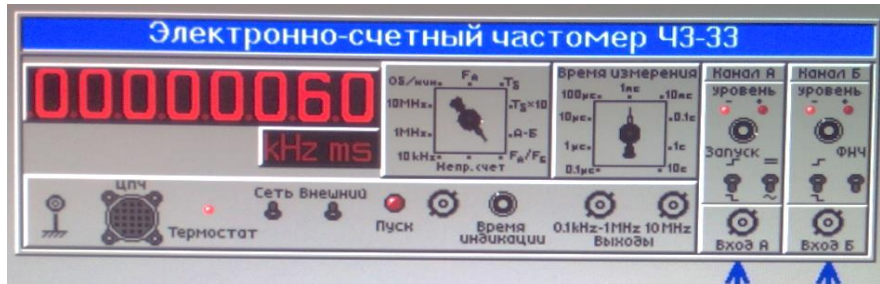
Рис. 5 - Работа виртуального ЭСЧ в режиме F_A/F_B
