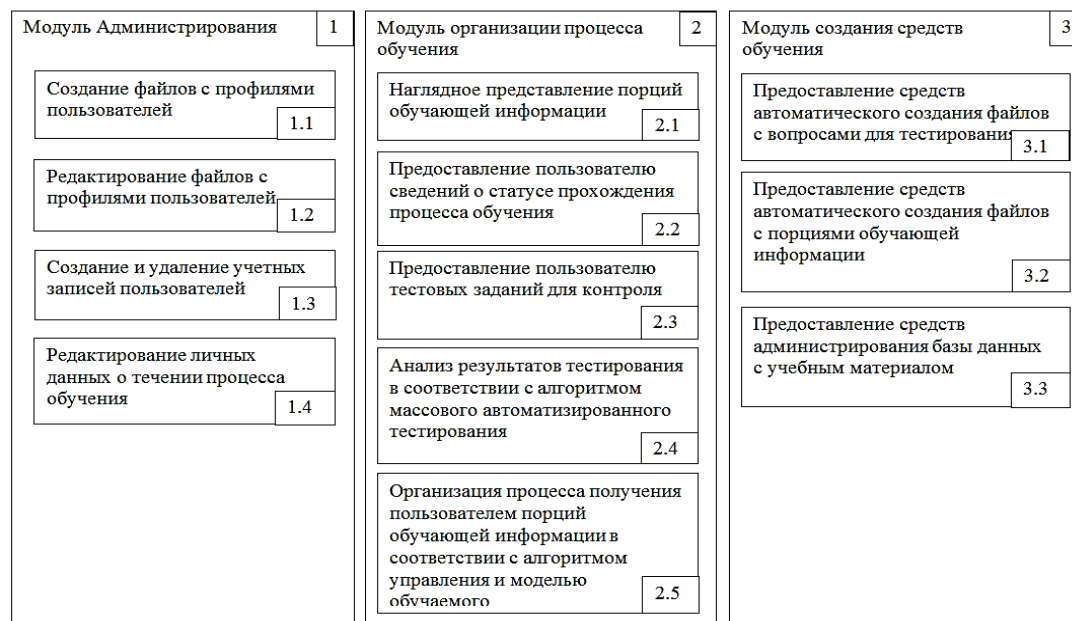
Рис. 2. Функциональные части модулей программного комплекса
