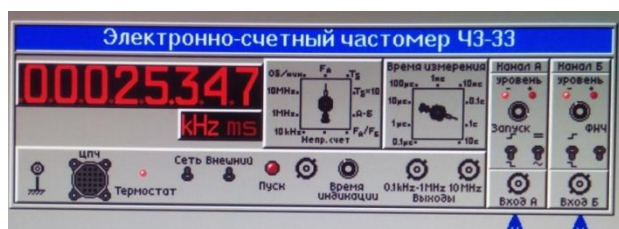
Рис. 3 - Работа виртуального ЭСЧ в режиме F_A при времени измерения T_{ИЗМ} = 1 с
