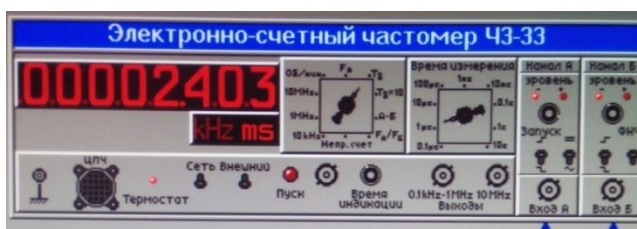
Рис. 4 - Работа виртуального ЭСЧ в режиме T_B для меток времени \tau_{МВ} = 1 \mu с
