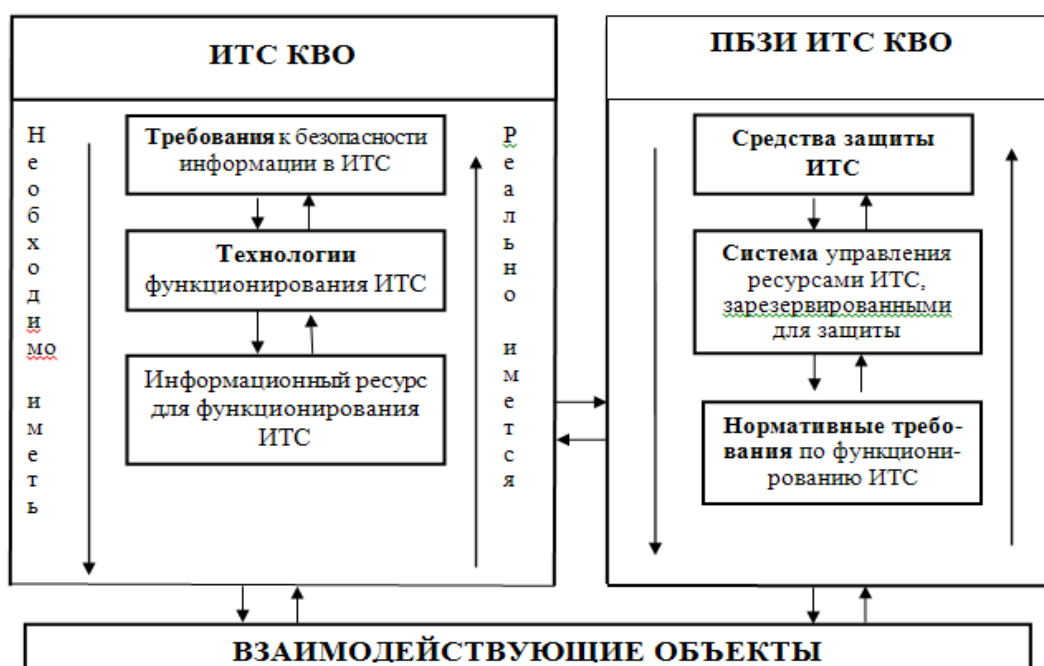
Рис. 1 - Схема взаимодействия ИТС КВО и его ПБЗИ
