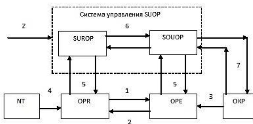
Рис. 1. Концептуальная схема OTS "Производство" OPR - основная технология в развитии; OPE - основная технология в эксплуатации; SUOP - система управления основной технологией в развитии; SOUOP - система оперативного управления эксплуатацией основной технологии; ОКР - обеспечивающие компоненты производства; NT - новая технология; Z - цель функционирования; C= 1,2,3,4 – материально - энергетические потоки; I= 5, 6 - информационные связи.
