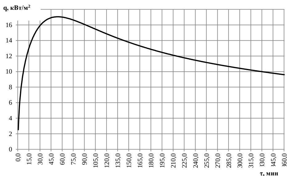
Рис. 2 - Изменение теплового потока со временем
