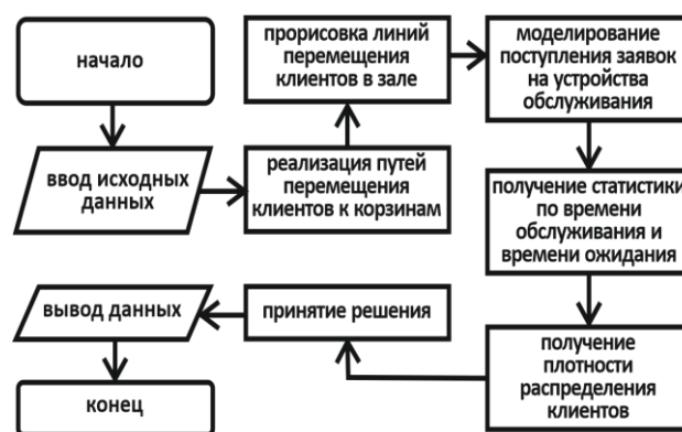
Рис. 3 – Блок – схема алгоритма имитации случайных несовместных событий
