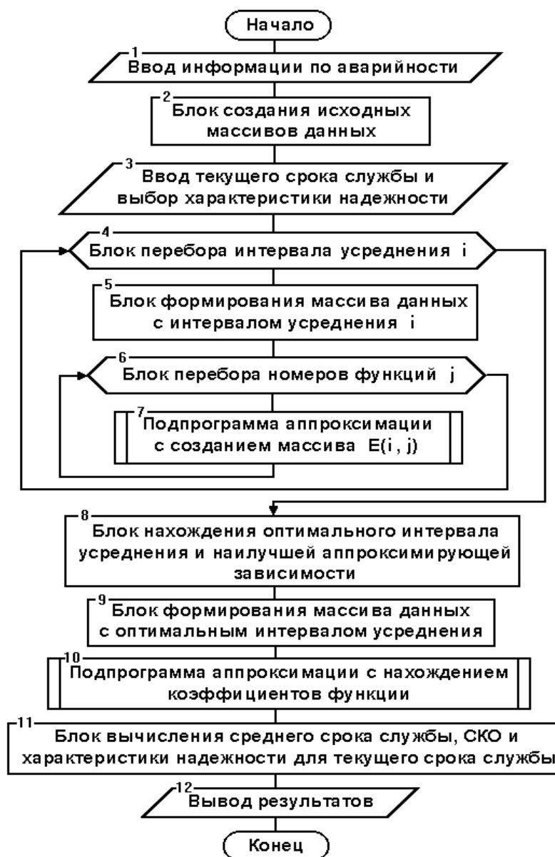
Рис. - Блок-схема алгоритма оценки состояния участка тепловой сети
