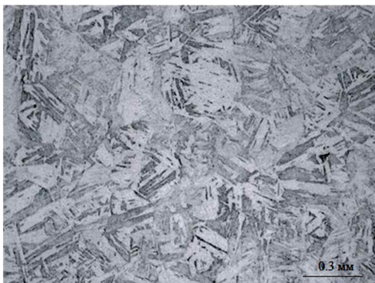
Рис. 7. Структура сплава 21HKMT: после обработки закалка + обработка холодом + всестороннее обжигание + старение После третьего режима МТО добротность составила Q=40000
