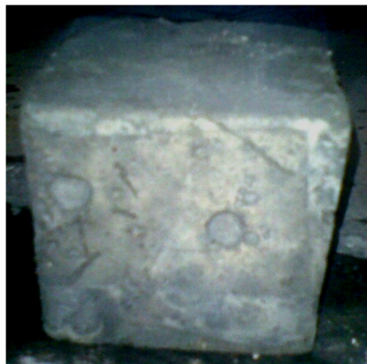
Рис. 3. Образец тяжелого бетона, модифицированного комплексной добавкой 0,1% нанотрубок и 0,5 % С-3, после второй теплосмены термообработки при 800 °С
