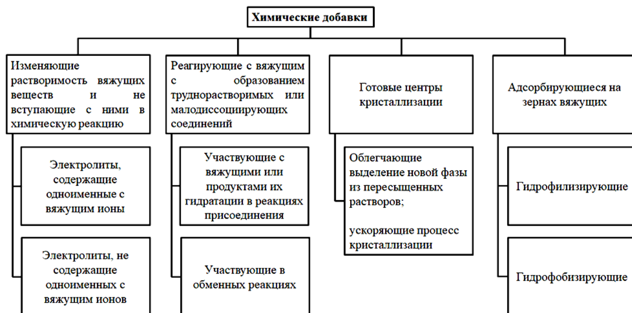
Рис. 3. Классификация химических добавок для цементных бетонов по механизмам их действия
