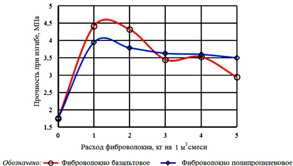
Рис. 2. Зависимость прочности при изгибе от вида и расхода фиброволокна
