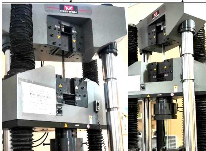
Рис. 8. Внешний вид оборудования в процессе проведения испытания УВ лент
