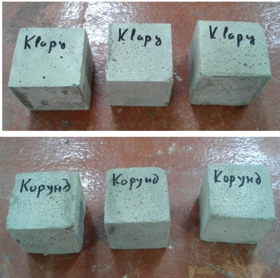
Рис. 3. Внешний вид образцов кубов  $7 \times 7 \times 7$  см, изготовленных из сухой смеси, предназначенных для испытаний на истираемость
