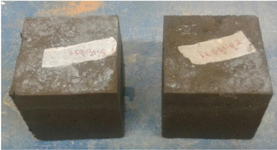
Рис. 2. Внешний вид свежееотформованных образцов кубов размером  $10 \times 10 \times 10$  см, изготовленных из сухой смеси, предназначенных для испытаний на сжатие
