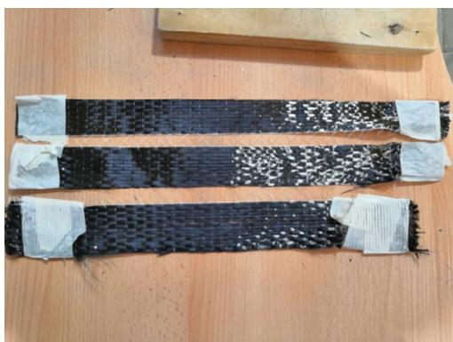
Рис. 7. Образцы УВ ленты Carbon Wrap® Resin 230+ подготовленные для испытания
