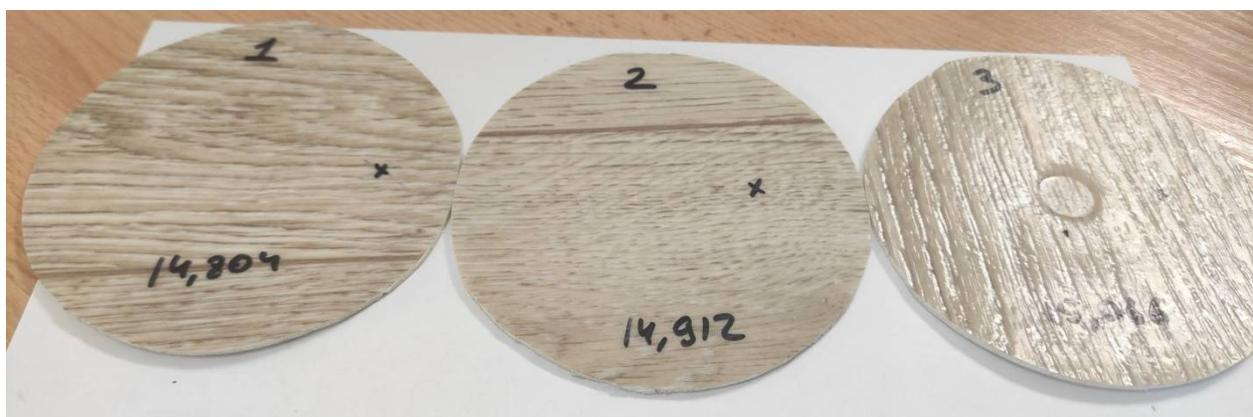
Рис. 6. Измерение остаточной деформации образцов линолеума, подготовленных по требованиям ТУ[4]
