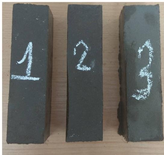
Рис. 4. Образцы для получения расчетной характеристики каучона
