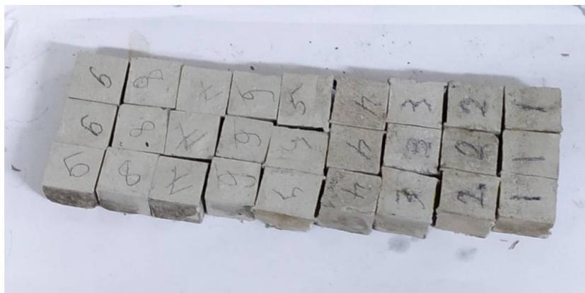
Рис. 4. Образцы модифицированного гипсового камня, 3 сутки твердения
