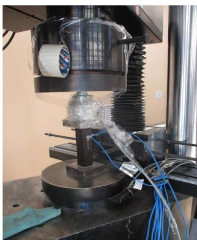
Рис. 6. Схема испытания каучон бетонного образца для получения деформации
