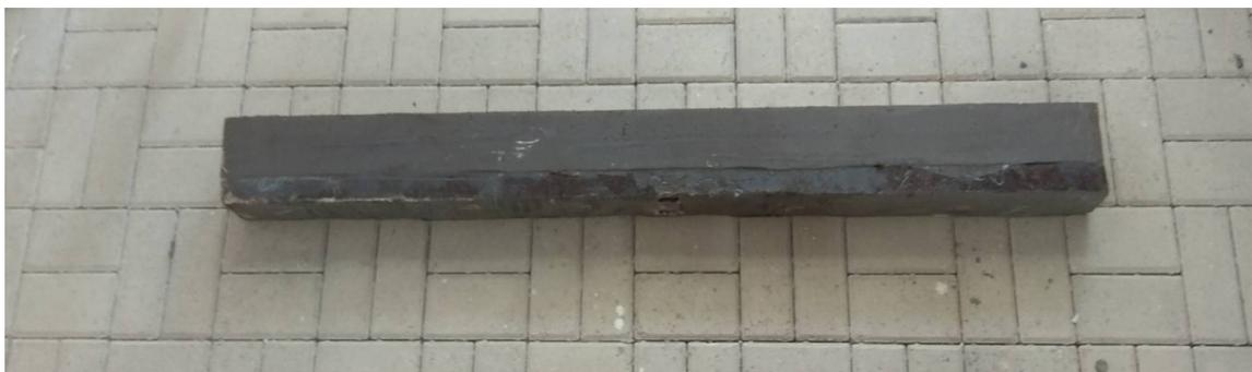
Рис. 3. Общий вид дерево-каучунового армированного составного мостового бруса
