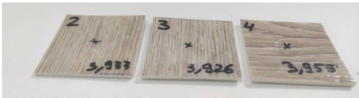
Рис. 5. Измерение остаточной деформации образцов линолеума, изготовленных по требованиям ГОСТ 11529-2016
