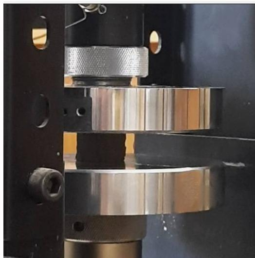
Рис. 1. Испытания прочности при сжатии твердеющих образцов на прессе
