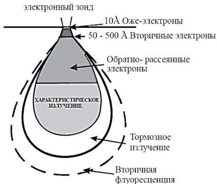
Рис. 1. Типы эмиссий, возникающих при взаимодействии электронного зонда с поверхностью образца [5]
