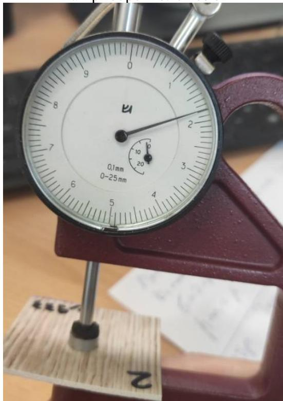
Рис. 8. Испытания по определению остаточной деформации образцов линолеума толщиномером индикаторным часового типа марки «Калиброн»
