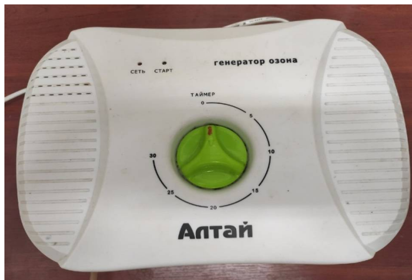
Рис. 2. Генератор озона «Алтай»
