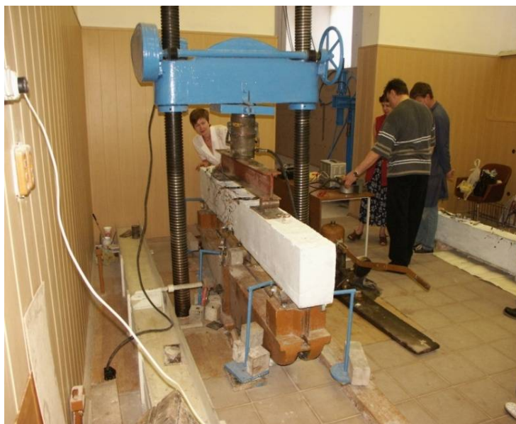
Рис. 1. Лабораторные испытания фибропеножелезобетонных перемычек
