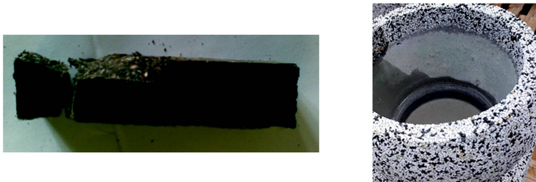
Рис. 5. Образец каутона (слева) и бетона с резиновой крошкой (справа) [7, 3]
