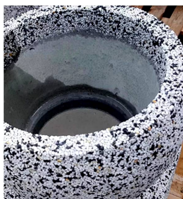
Рис. 2. Образец цементобетона с добавлением резиновой крошки [3]
