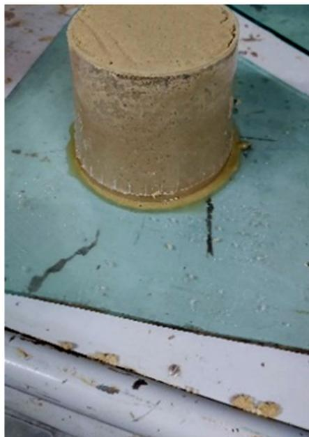
Рис. 1. Фото результатов экспериментальной оценки водоудерживающих свойств заполнителя
