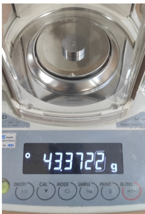
Рис. 2. Фотофиксация процесса измерения массы образцов
