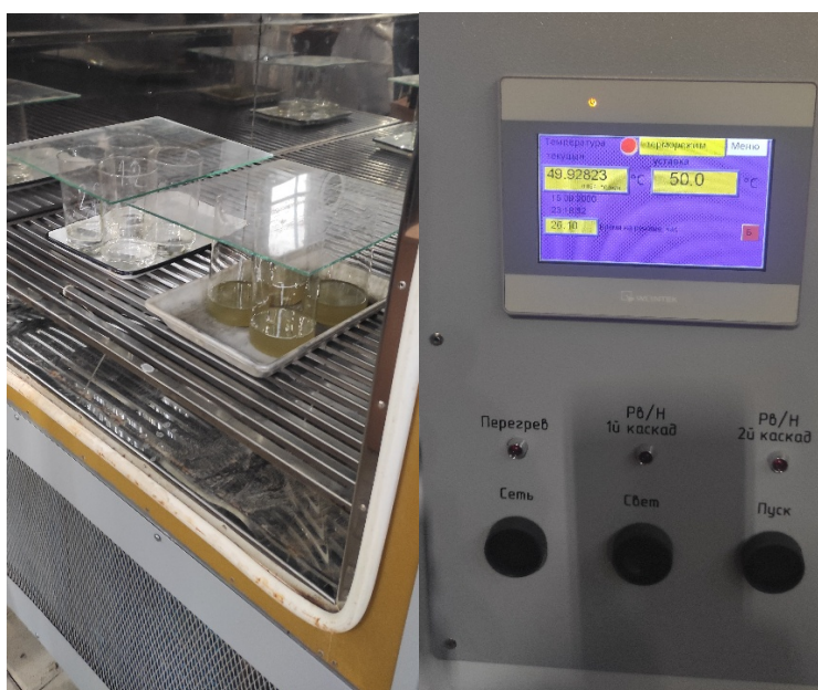
Рис. 3. Фотофиксация процесса испытаний образцов в разных «испытательных средах» при температуре 50 °С в течении 48 часов в климатической камере М-60/100-1000 КТВХ
