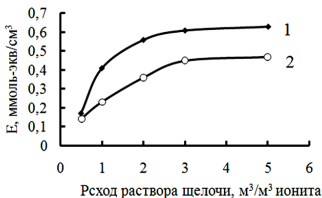
Рис. 4. Зависимость рабочей обменной емкости анионитов от расхода раствора щелочи на регенерацию. Варион АДМ 2 - АВ-17-8
