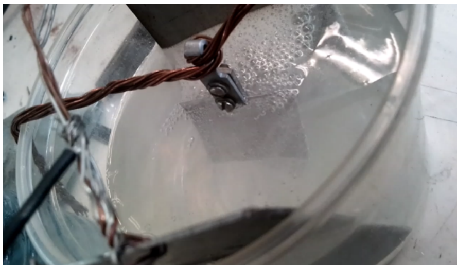
Рис. 1. Образование газообразного кислорода на аноде при окислении алюминия в 15% растворе NaCl при T раствора 40С, катод нержавеющей сталь X18H9T
