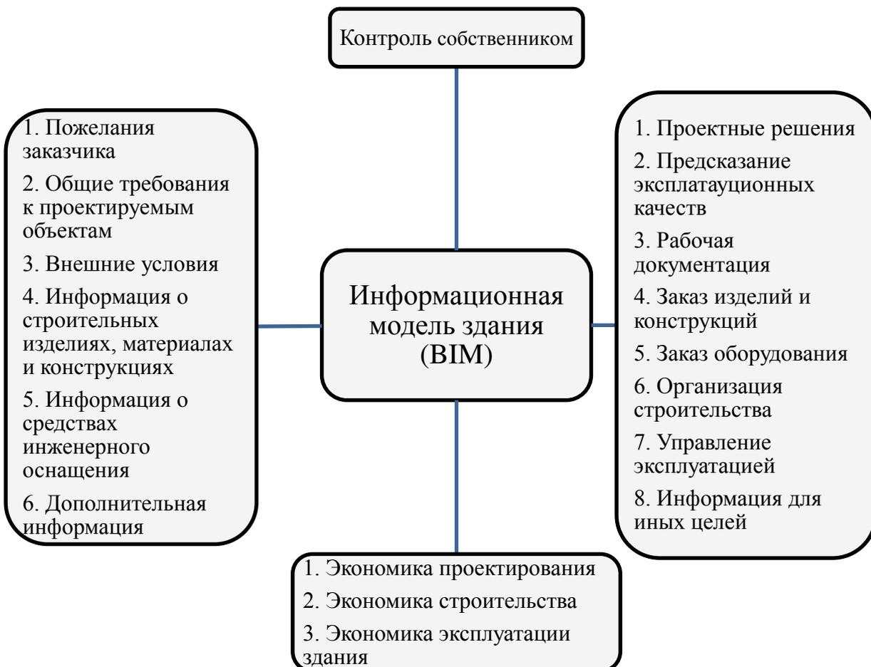
**Рис. 1. Основная информация, которая проходит через BIM и имеет к BIM непосредственное отношение**
