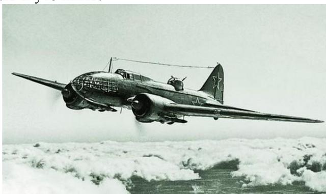
**Рис. 8. Модернизированный ДБ-3, получивший название Ил-4**
