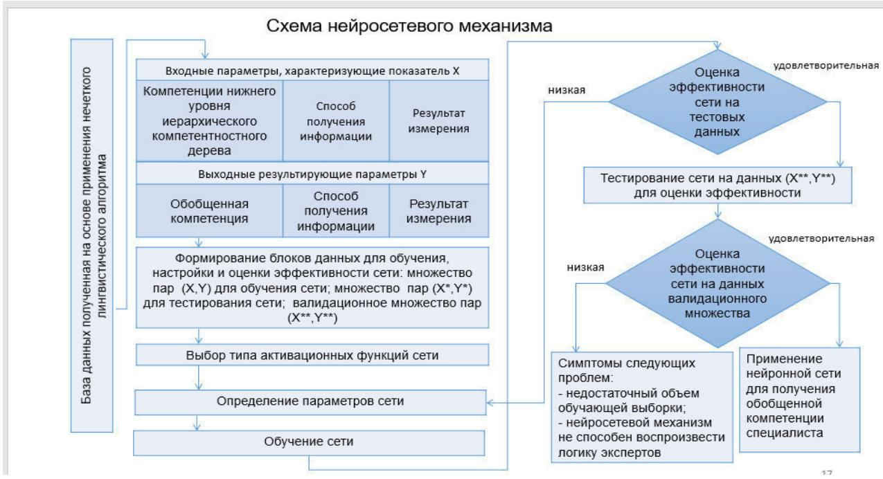
**Рис. 6. Структурная схема нейросетевого механизма**
