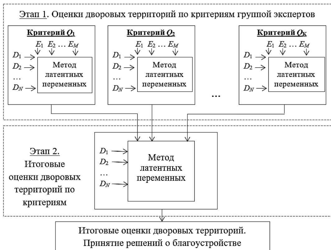
Рис. 4. Схема обобщения многокритериальных экспертных оценок состояния дворовых территорий, сначала по экспертам, потом по критериям
