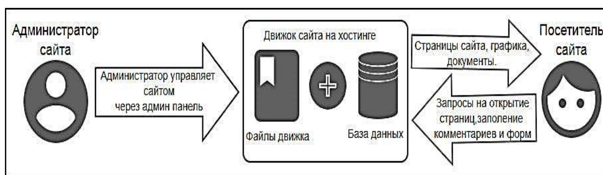
Рис. 2. Простая схема работы CMS
