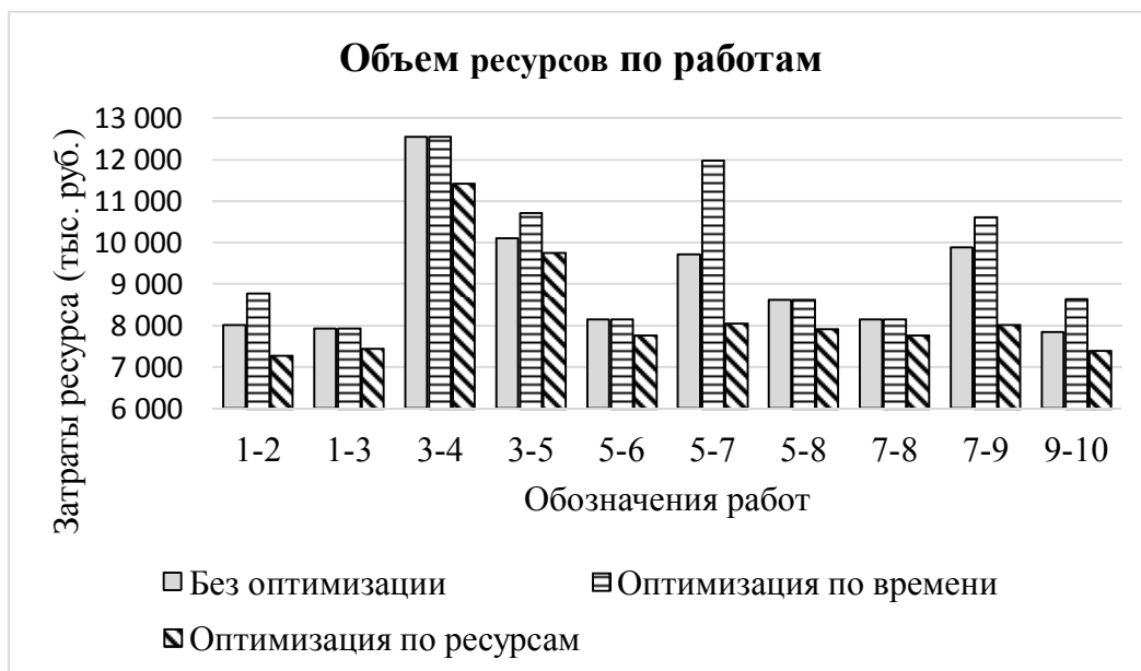
Рис. 17. Распределение ресурсов между работами при их оптимизации при гиперболической зависимости между временем и ресурсами
