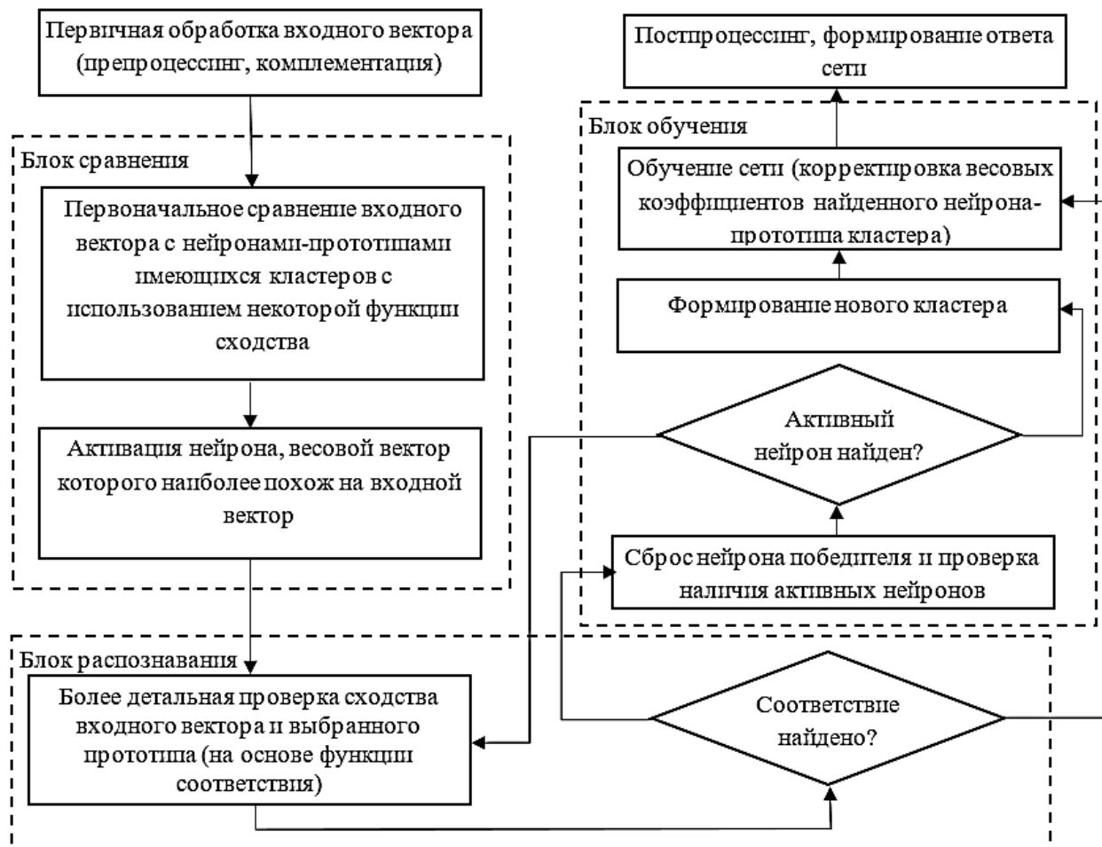
Рис. 3. Базовый модуль кластеризации в архитектуре сетей семейства ART
