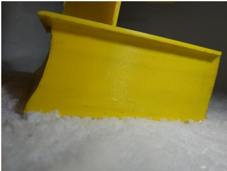
Рис. 1. Модель двухстороннего снегоочистителя на лабораторной установке.
