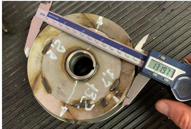
Рис. 2. Задний диск рабочего колеса до подрезки
