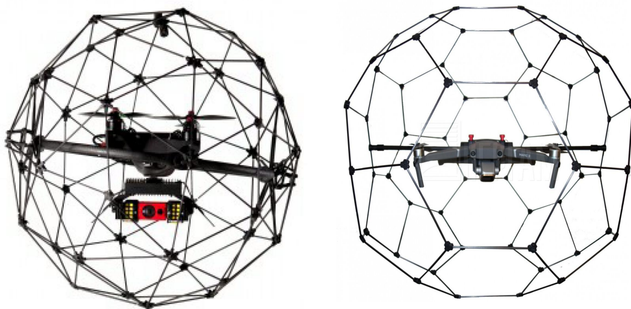
Рис. 1. Форма защиты квадрокоптера и устройств диагностики при работе в опасных зонах
