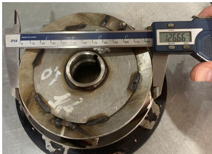
Рис. 5. Задний диск рабочего колеса после подрезки
