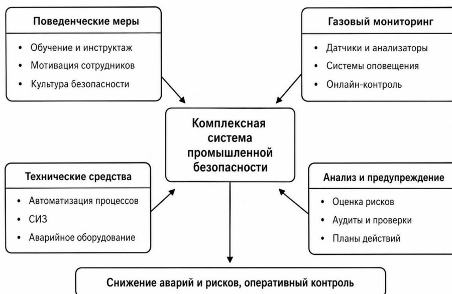
Рис.1. Схема адаптивной системы управления производственными рисками
