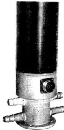
Рис. 1. Общий вид гидростатического датчика прибора СГН-
