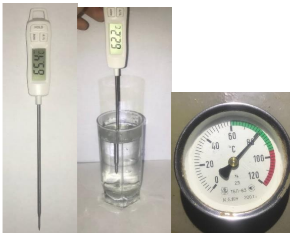
Рис. 3. Датчики съёма температуры показателей с емкости косвенного нагрева и котла
