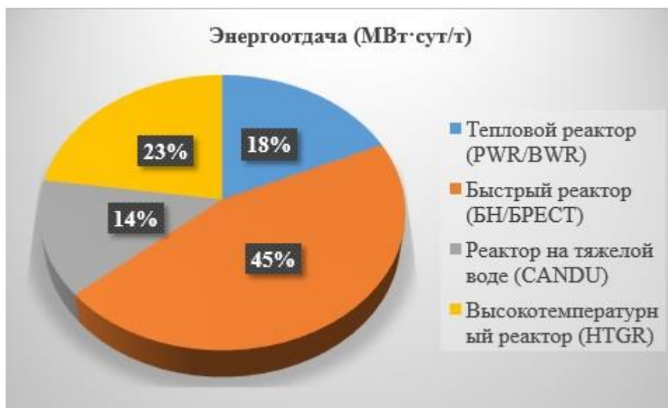
Рис. 2. Энергоотдача урана в разных типах реакторов
