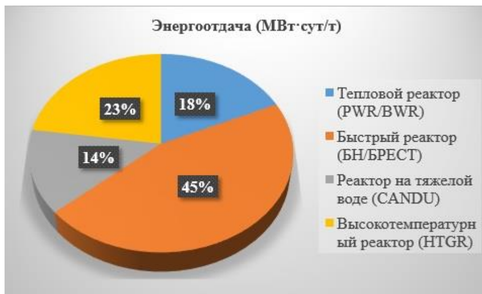
Рис. 2. Энергоотдача урана в разных типах реакторов
