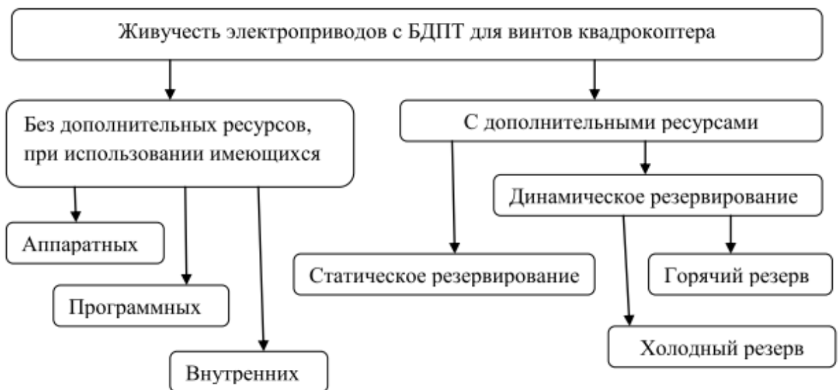
Рис. 2. Повышение живучести электроприводов на базе БДПТ для винтов квадрокоптеров
